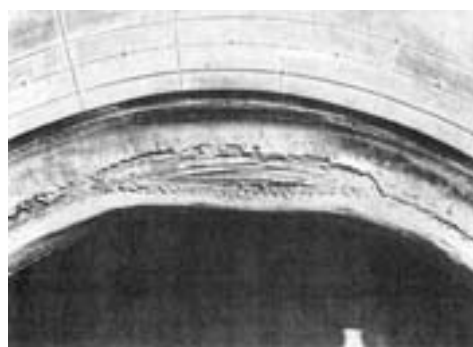
Рис. 27. Повреждение борта из-за неисправности обода
