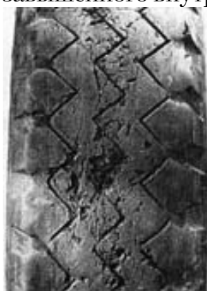
Рис. 18. Выщербленная поверхность протектора, образование трещин, порезы
