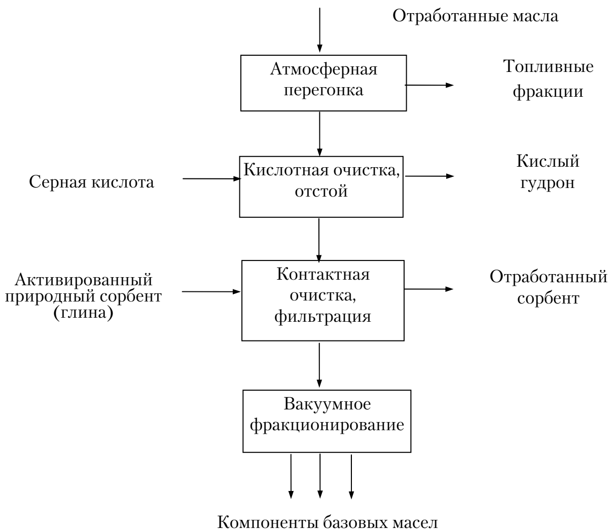
Рис. 36. Схема кислотно-контактной очистки отработанных масел
