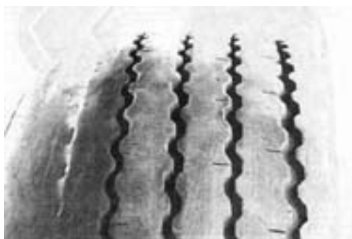
Рис. 9. Преждевременный односторонний износ в плечевой зоне
