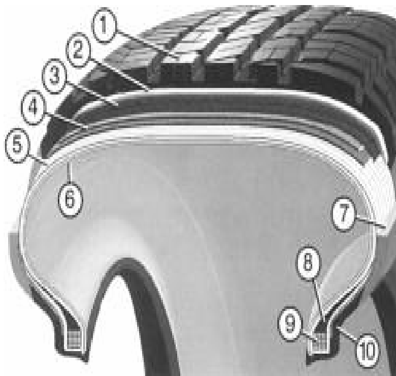
Рис. 5. Строение многослойной шины:
