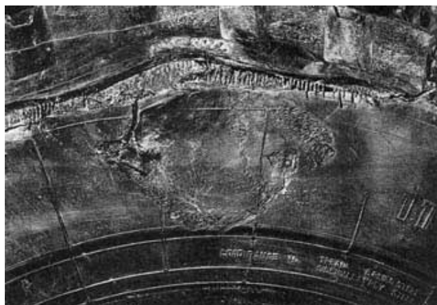
Рис. 22. Разрыв каркаса в результате застревания камней между сдвоенными шинами
