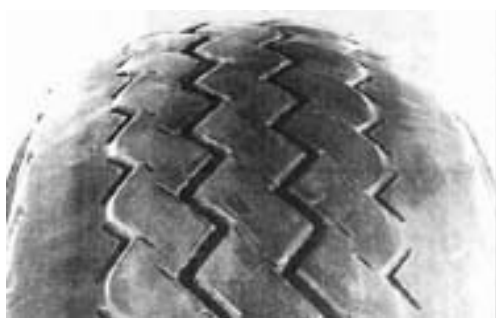
Рис. 10. Преждевременный двухсторонний износ в плечевой зоне
