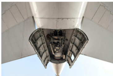
Рис.1. Розташування відсіку допоміжної силової установки (APU) на літаку
