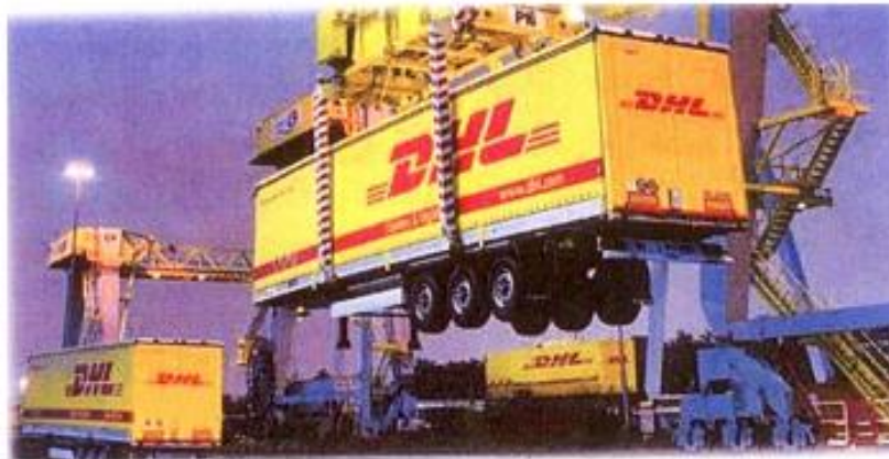
Рис. 7 – Технологія перевезення знімних кузовів
