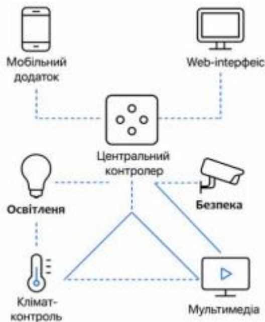
Рисунок 1.5 – Гібридна архітектура системи «розумний будинок»
