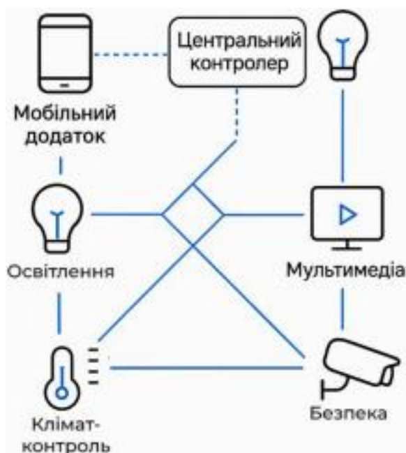
Рисунок 1.4 – Децентралізована архітектура системи «розумний будинок»
