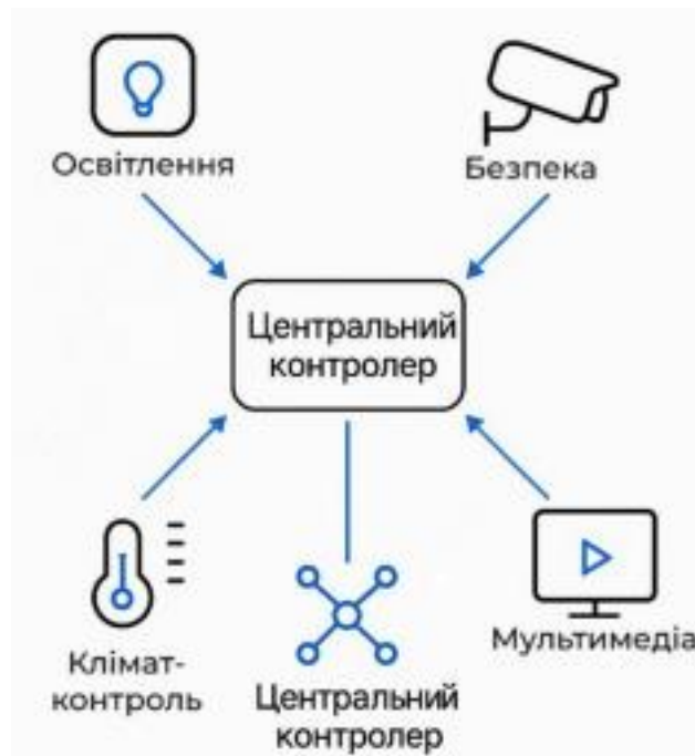
Рисунок 1.3 – Централізована архітектура системи «розумний будинок»
